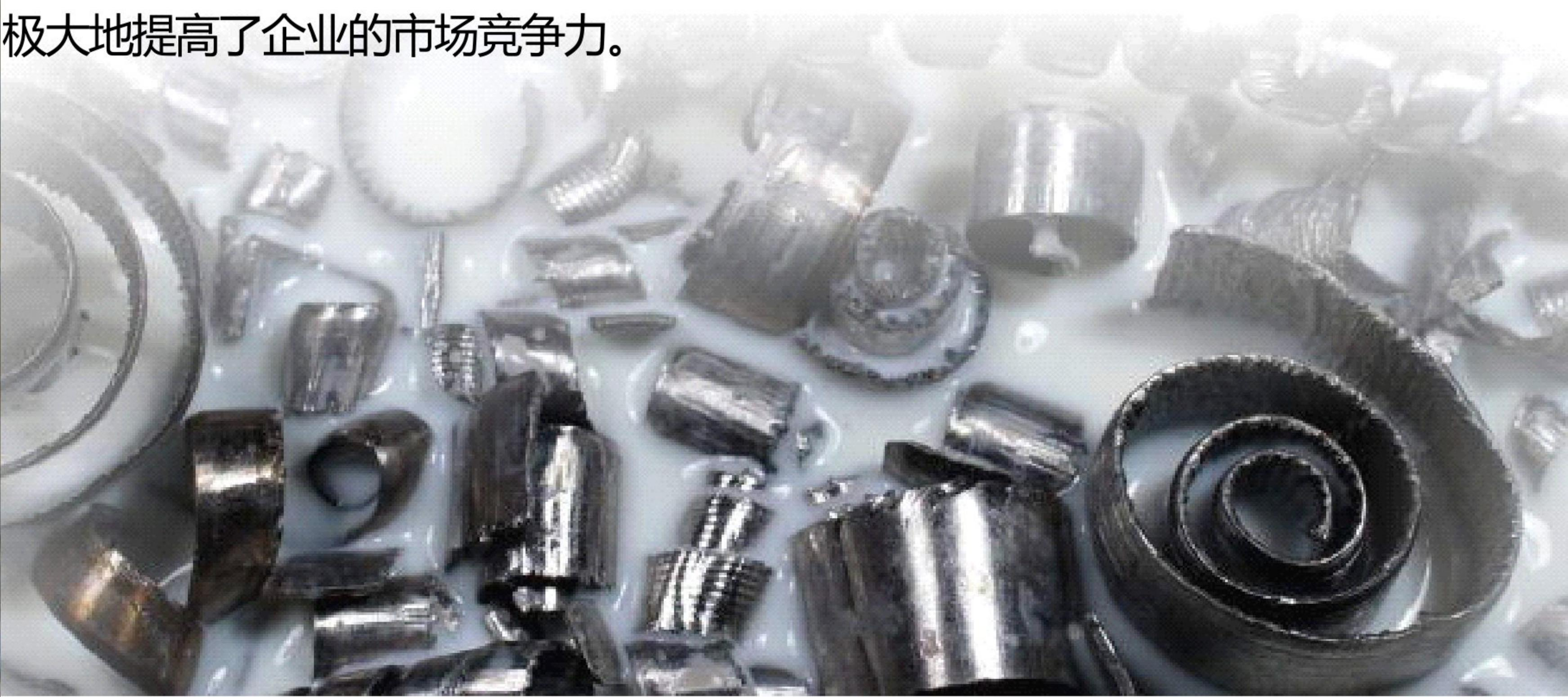
钢屑的物理形态差别较大，颗粒大小有几毫米到几米不等，较长的钢屑材料，成团成卷，相互勾扯，不易采用机械化输送手段，大多只能采取人工分拆铲运。
